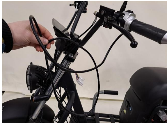
Pujottele vasemman kahvarungon johto irralleen.
