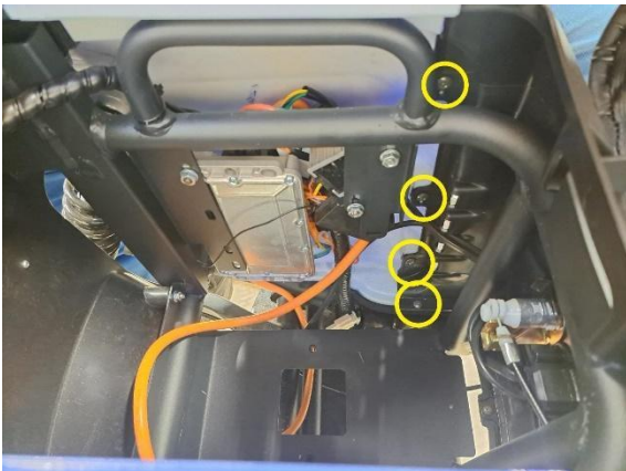
Irrota istuimen vasemmanpuoleisen alasivumuovin kiinnitysruuvit (ristipäämeisseli ph2).
