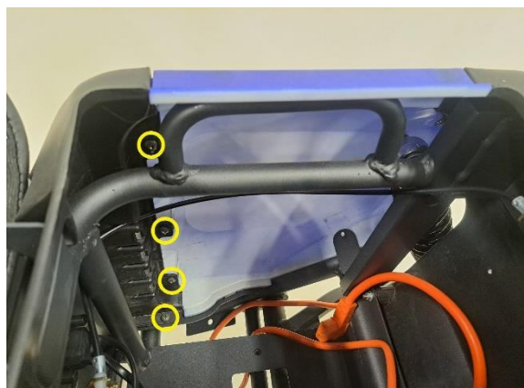
Irrota istuimen oikeanpuoleisen alasivumuovin kiinnitysruuvit (ristipäämeisseli ph2).
