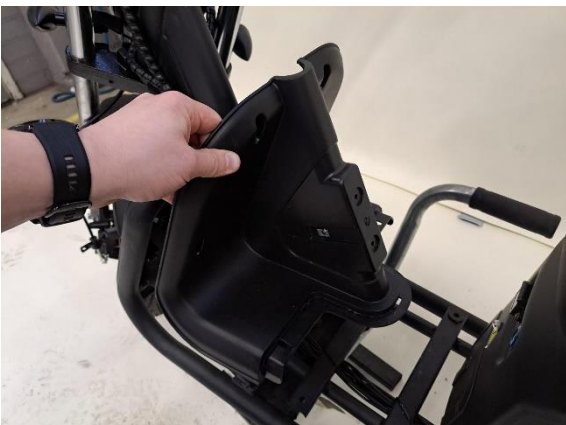
Ota jalkatilan etuosan muovi pois.
