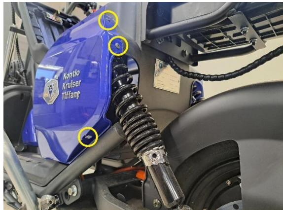
Irrota istuimen vasemmanpuoleisen alasivumuovin kiinnitysruuvit (ristipäämeisseli ph2).
