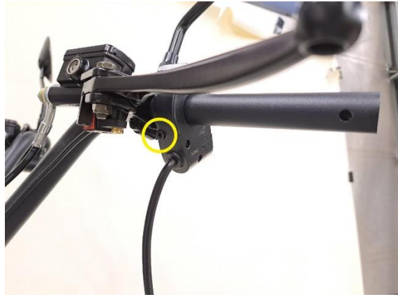
Löysää vasemman kahvarungon lukitusruuvia (kuusiokoloavain 3 mm).
