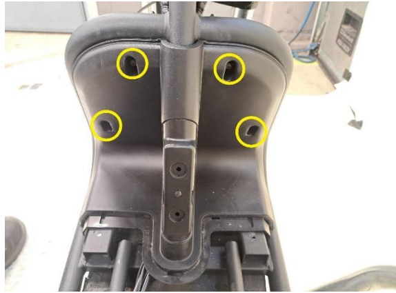
Irrota jalkatilan etuosan muovin kiinnitysruuvit (ristipäämeisseli ph2).
