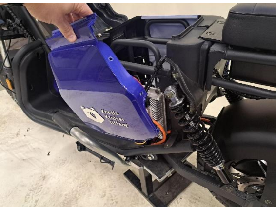
Ota istuimen vasemmanpuoleinen alasivumuovi pois.
