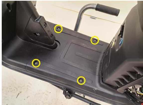
Irrota jalkatilan muovin kiinnityspultit (kuusiokoloavain 5 mm).
